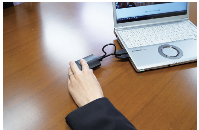
▲PCのHDMI端子にPressITの送信機を接続。天面のボタンを押すだけで画面共有を開始できる
