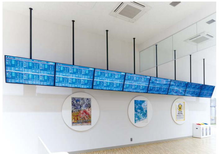
▲入り口すぐの壁面にはTH-55LFE8Jが8台横並びに設置。8場分のオッズ情報や成績がリアルタイムに表示される
