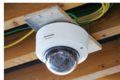
▲AIマスク非着用検知アプリケーションがインストールされたAIドームタイプネットワークカメラ
