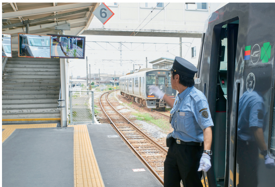
▲4両編成の特急列車の運転士用のホーム確認用モニターとして、TH-47LFX60Jが導入された(写真:国分駅)
