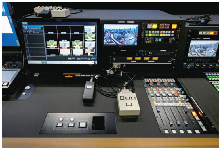
▲報道サブのコンパクトOTCシステム。OPT端末と16面操作端末が1つになったコンパクト設計で、場所を取らずに配置できると好評
