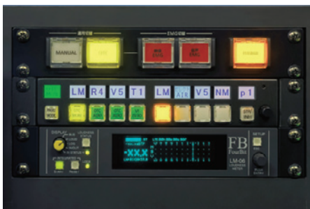
▲OTC卓に埋め込んだ制御ボタン。左上の「運用切替」を押せば映像・音声ともにマニュアルとOTCのシステムを一括で切り替えることができる
