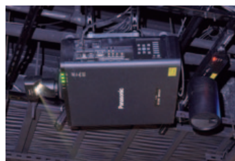
▲ミラーが内蔵された固定焦点レンズ(超短焦点レンズ)ET-DLE035は、設置方向の反対側に反射させることで投写距離を大幅に短くできる
