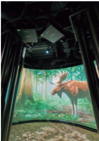
▲DLP®機種の実像表現力と超短焦点レンズET-DLE020を活用することで、木々に囲まれた狭いエリアや曲面のスクリーンにも綺麗に投写
