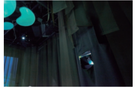
▲壁の中に下向きに埋め込んだプロジェクターに固定焦点レンズ(超短焦点レンズ)ET-DLE035を付けることで、床にプロジェクターを置くことなく天井への投写を実現
