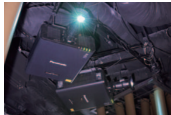
▲DLP®機種の実像表現力と超短焦点レンズET-DLE020を活用することで、木々に囲まれた狭いエリアや曲面のスクリーンにも綺麗に投写
