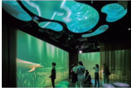
▲“水の中”を体験できるアンダーウォーターゾーン。超短焦点レンズET-DLE020の活用により、お客様の影はスクリーンに映らない。また、天井にも生き物を投影しており頭の上を巨大なワニが泳ぐ
