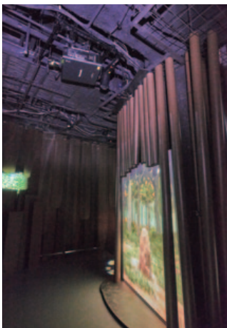
▲ミラーが内蔵された固定焦点レンズ(超短焦点レンズ)ET-DLE035は、設置方向の反対側に反射させることで投写距離を大幅に短くできる
