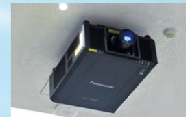
▲大講義室の天井に設置された3チップDLP®レーザープロジェクターPT-RZ21KJ
