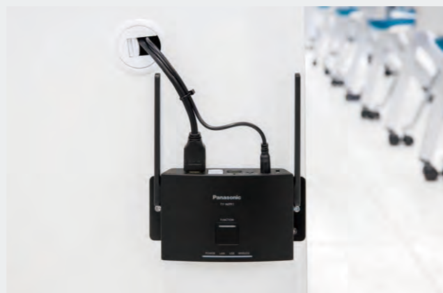
▲教卓の端に設置されたPressITの受信機。1台の受信機で最大32台の送信機に接続可能
