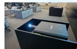
▲PT-RQ22KJとET-D75LE95の採用でフロント投写を省スペースに実現
