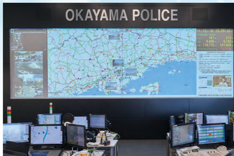
▲室内後方からも地図情報がはっきりと見える超高解像度200インチ×横2面の映像表示
