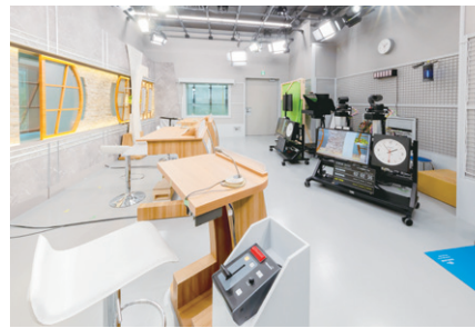
▲報道フロアの中につくられたL2サブ。中央にOTCシステムを配置し、左手にライブスイッチャーAV-HS6000を配置した
