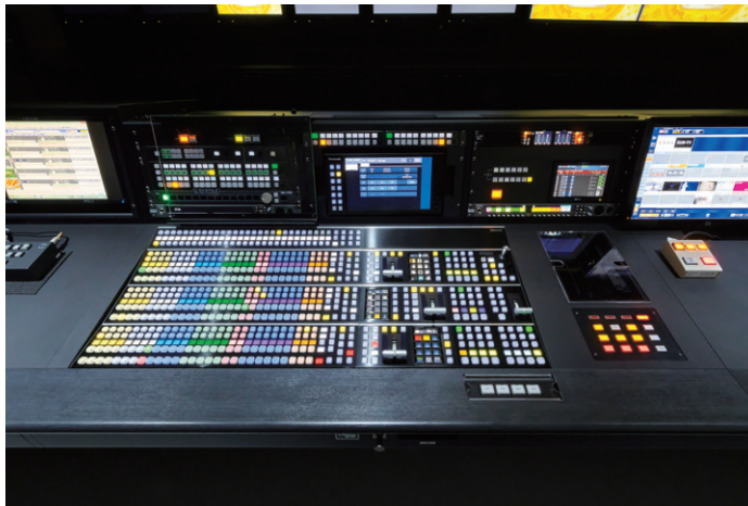
▲L1サブのライブスイッチャーAV-HS7300。なお、新社屋ではIP KVMを導入したことで、操作卓周辺のモニターやキーボード、マウスの数を半数以上減らすことができました
