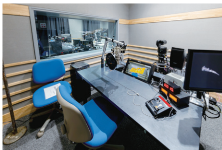
▲L3サブの隣につくられたアナブースにはリモートカメラAW-UE150を1台設置。コンパクトな筐体が設置の自由度を高め、壁に近づけて置けるため、カメラ1台で2名の演者を撮影することができる
