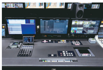
▲L2サブのOTCシステム操作卓。1名で放送ができるようOTCの周辺にはリモートカメラコントローラーやOTCミキサーが配置されている
