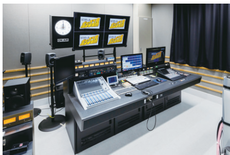
▲年間50本以上の野球中継を行う大人気番組「サンテレビボックス席」などが制作される受けサブ「L3サブ」。スイッチャーは持ち運べるほどコンパクトなAV-UHS500を採用
