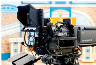
▲液晶ビューファインダーをビルドアップユニットに装着した4KスタジオカメラAK-UC4000
