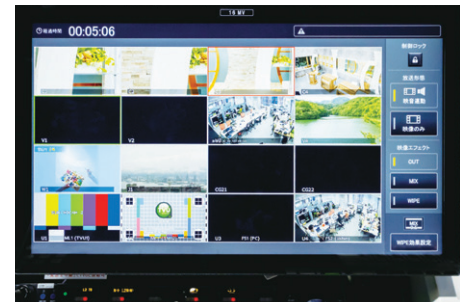
▲直感的な操作が可能なOTCシステムの16面操作端末
