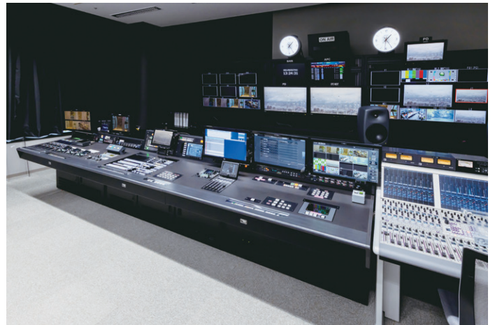
▲報道フロアの中につくられたL2サブ。中央にOTCシステムを配置し、左手にライブスイッチャーAV-HS6000を配置した
