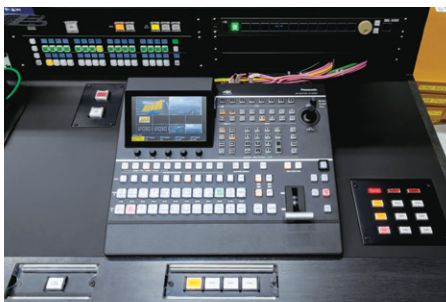
▲AV-UHS500本体。4K対応スイッチャーのため、L1スタジオの4Kスタジオカメラと組み合わせることで将来の4K番組制作にも対応できると選定された
