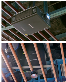
▲車体投写用にはPT-RZ970JBが、床面投写用にはPT-RZ770JBが採用された
