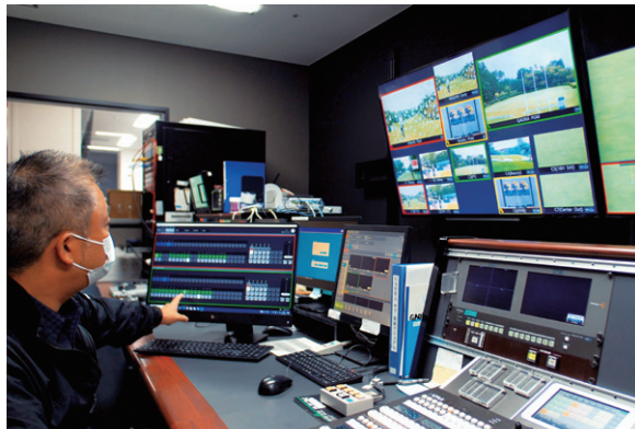
▲CS放送「GAORA」のサブ。GUIソフトウェア「Kairos Creator」を使ってタッチパネルモニターで操作を行った
