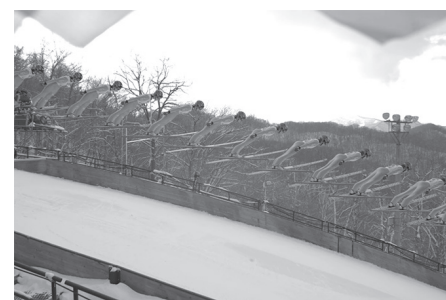
重心の移動などの分析が容易な動作解析システムではコマ送りのように画像が連なって見える
