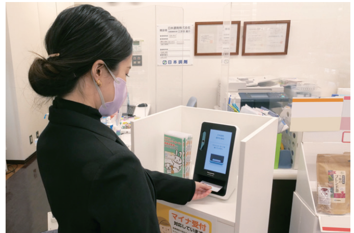
▲受付の前の専用台に設置された顔認証付きカードリーダー
