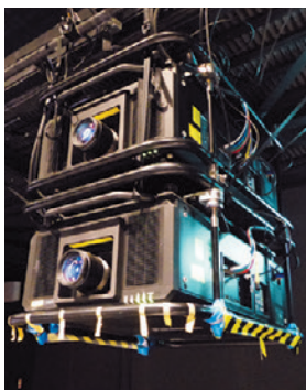
▲ホール中央に設置したRQ32K×2台
