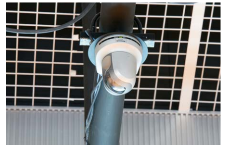
▲天井トラスに設置されたリモートカメラ。実験時の手元の様子をプロジェクターで投写
