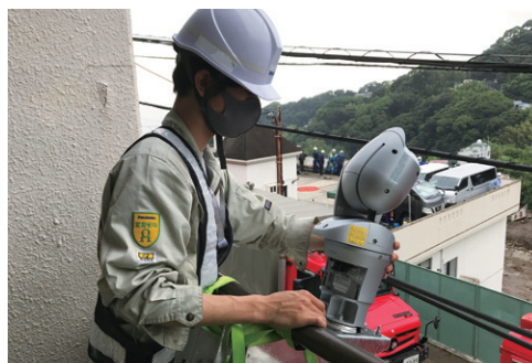
▲素早く設置される屋外PTZタイプの災害対策用カメラ「エアロPTZ」AF-KSUD638
