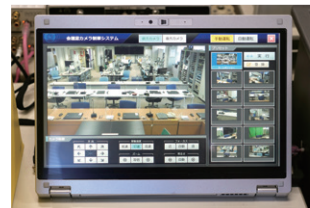
▲リモートカメラをコントロールするためのオリジナルソフトウェアは災害対策本部室での使いやすさを追求
