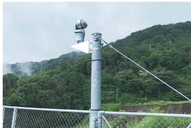
▲静岡県熱海市伊豆山で発生した土石流災害時に臨時で設置された屋外PTZタイプの災害対策用カメラ「エアロPTZ」AF-KSUD638
