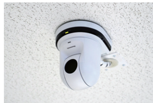
▲災害対策本部室で行う本部会議などをWEB会議で配信し、整備局管内の情報共有を図ります。映像はNDI®|HX対応リモートカメラAW-HN70シリーズで撮影
