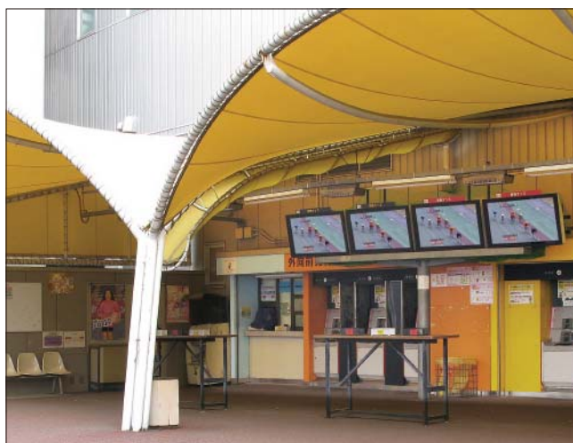
▲屋外に設置するためディスプレイには防水性が求められる。また、気温変化の影響も受けやすいため、温度の動作範囲が広い堅牢液晶ディスプレイが最適。
