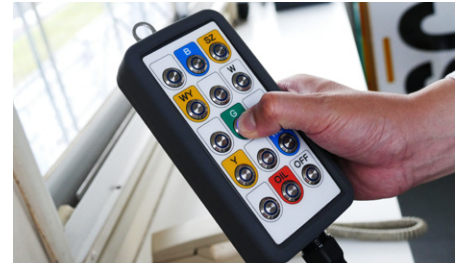
ポストに設置されたLEDパネル型信号機のコントローラー
