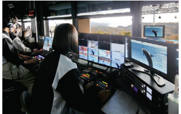
▲コントロールルームでは2台のリモートカメラコントローラー AW-RP50でカメラ操作
