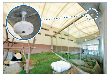
屋内運動場では、仕切られた2部屋を1台の全方位カメラで端から端まで撮影可能
