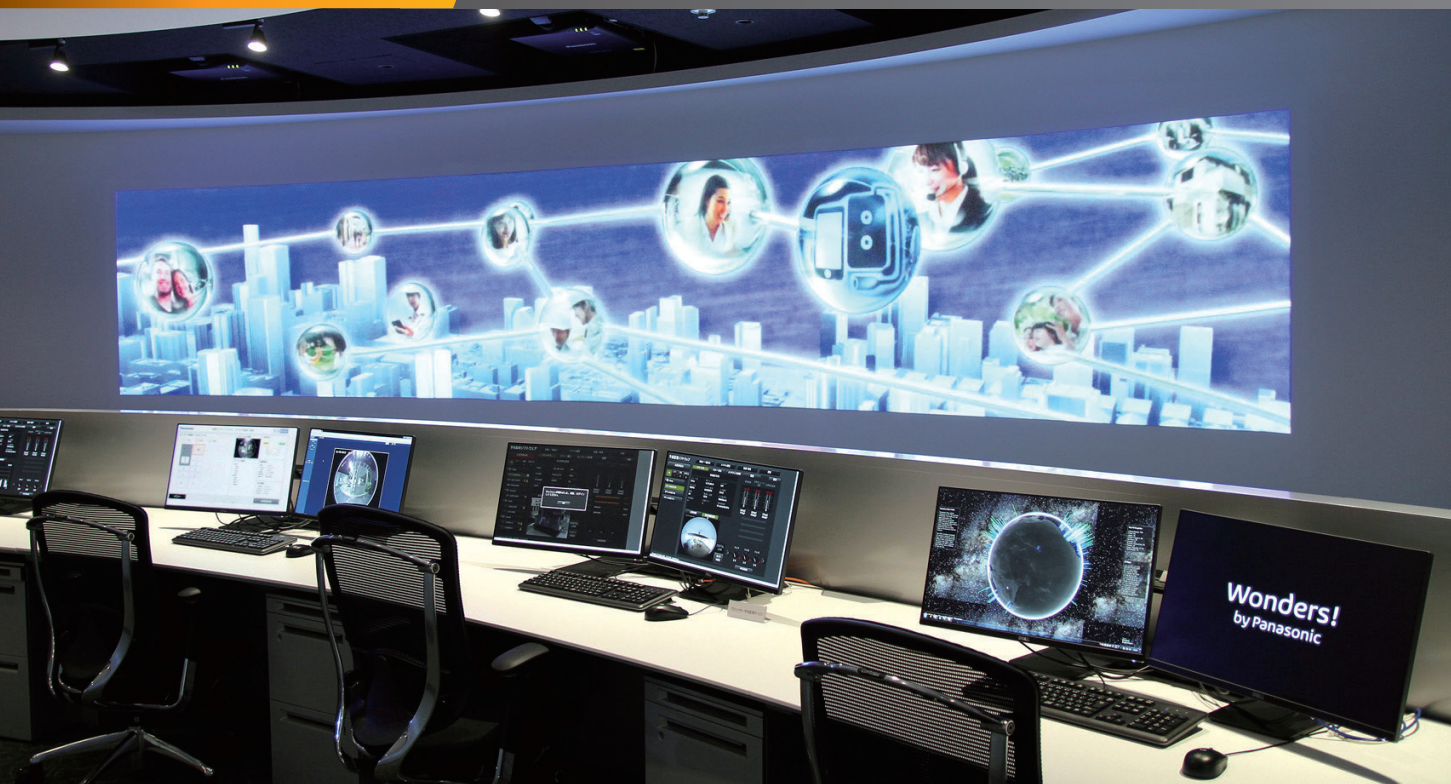
超短焦点レンズを装着した3台のプロジェクターからカーブドスクリーンに投写
