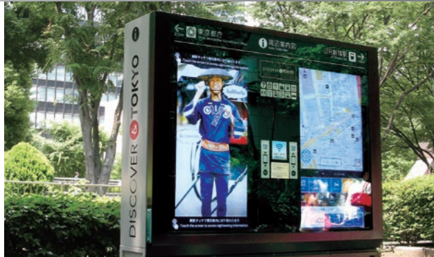
2台の屋外用サイネージ液晶ディスプレイにタッチパネルを組み合せ、直感的な操作を可能に
