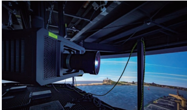
合計5台のPT-RQ13Kプロジェクターが設置され、シームレスなパノラマ映像を実現
