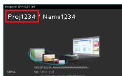
ネットワーク ID の表示箇所 (プロジェクターの映像例)
