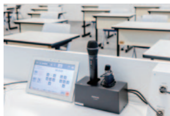
◀ 普通教室の1.9 GHz帯デジタルワイヤレスマイクシステムとワンタッチコントロールパネル
