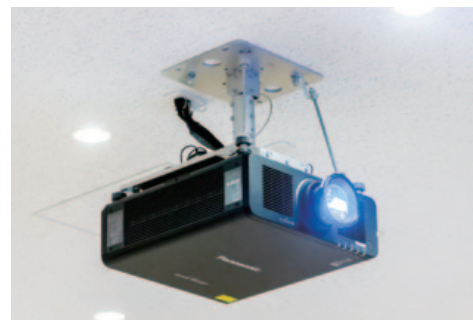
▲ 視聴覚室に設置された1チップDLP®レーザープロジェクターPT-RZ120JLB
