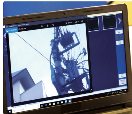
支社のパソコンからカメラを操作して静止画を撮影。静止画を拡大して細かい文字や形状を確認
