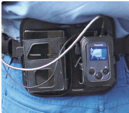
ウェアラブルカメラ本体部とUSBモバイル電源を腰ベルトで携帯
