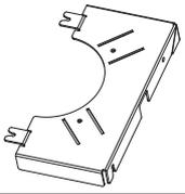
1 個                     | 本部品はレンズ固定アタッチメント取付金具に取り付けます。レンズ固定金具の位置調整・固定をするための金具です。                                                                                                   |
