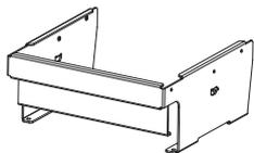
1 個                      | 本部品はプロジェクター本体に取り付けます。レンズ固定アタッチメント金具を取り付けるための金具です。                                                                                                        |
