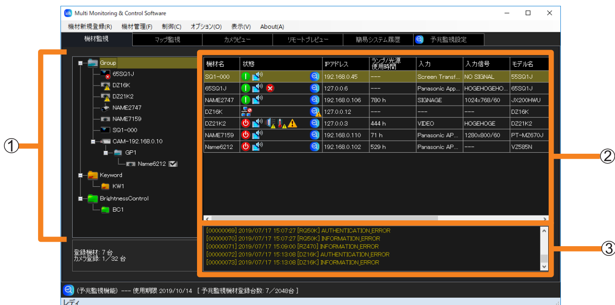
機材監視画面
