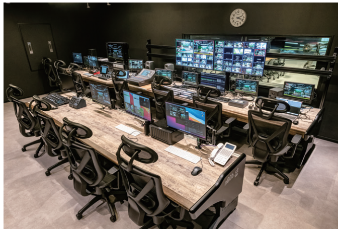
▲ KAIROSが設置されたサブルーム。2面のマルチビューはレイアウトを自由に変更することが可能
