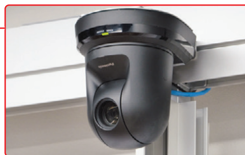
▲LANケーブル接続したAW-HE70HK9を壁面スクリーンの上に設置
