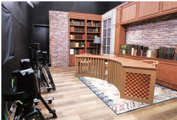
▲ 4KインテグレートカメラAW-UE100Kが4台導入されたT4スタジオ。4Kで撮影し2Kでクロップしているため、1台のカメラにつき3〜4つの映像が撮影できる
