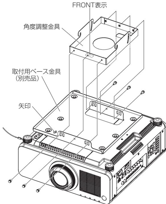
左図のように、付属の座金組み込み六角ボルト（M6 × 16）6 本で角度調整金具を取付用ベース金具に固定する。
