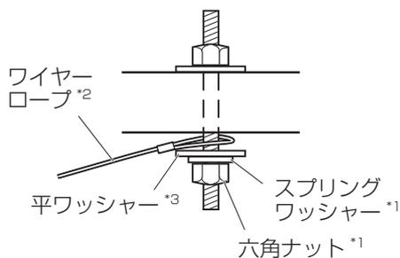
1) アンカーナットまたはカールプラグ (M8) を、しっかりしたコンクリート天井 (左図の範囲内1か所) に取り付ける。
