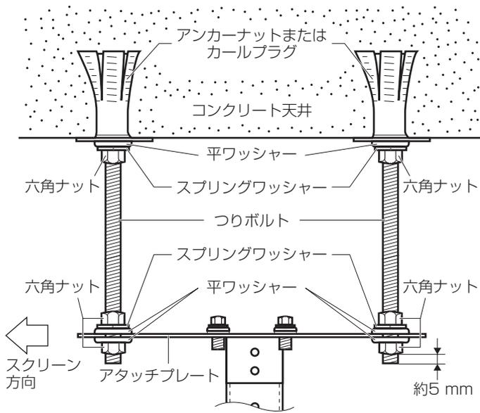
1) コンクリート天井にアンカーナットまたはカールプラグを取り付け、つりボルト4本をしっかりと固定する。(取り付け位置は7ページを参照してください)
