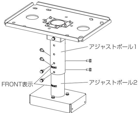
アジャストポール 1 にアジャストポール 2 を差し込み、穴の位置を合わせて付属の座金組み込み六角ボルト (M6 × 16) 6 本でしっかりと固定する。
