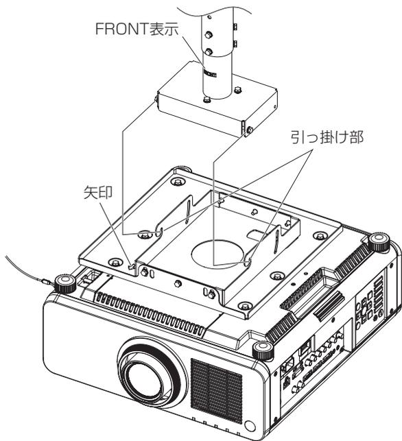
2) 仮止めした左右の座金組み込み六角ボルトに、角度調整金具の引っ掛け部をはめ込む。
