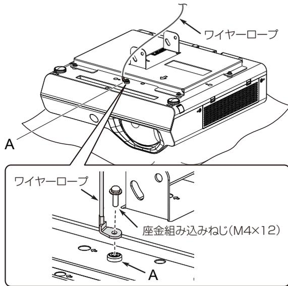
図のように、付属のワイヤーロープの先端(丸型端子側)を、付属の座金組み込みねじ(M4×12) 1本を用いてプロジェクターのA部に固定する。
