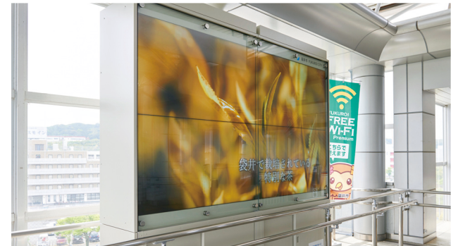
▲IPSパネルの採用で斜め方向から見ても鮮明な映像を表示。また、降雨に対応する天板や堅牢性に対応した強化ガラスを採用した筐体もオリジナルで設計した
