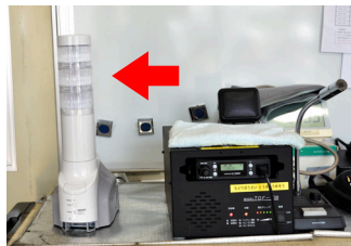
▲センサーの検知場所が光でわかる(矢印)。
