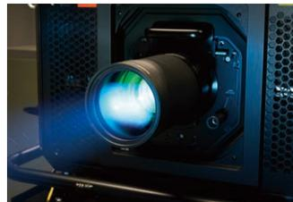
▲メインホールに映像を投写している最高輝度50,000 lmのPT-RQ50KJ。
