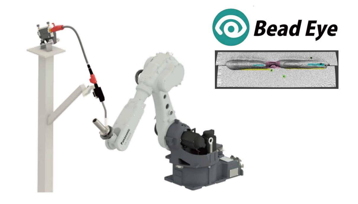
マテハンロボットとの 組み合わせによる フレキシブルな溶接システム
