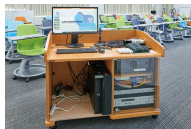
▲ アクティブラーニング室、ICT室に設置された1.9GHz帯デジタルワイヤレスマイクシステム。安定した通信で、円滑な授業進行に貢献。
