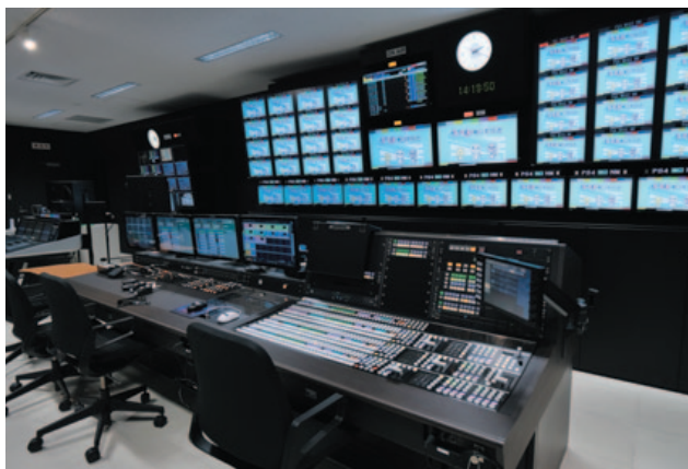
▲12G-SDI対応ライブスイッチャーAV-HS8300。60入力20出力、3ME(4KEYER/ME)+8DSKで採用
