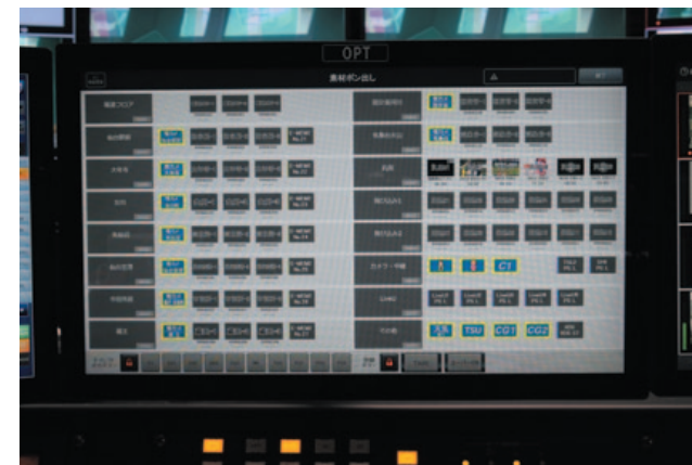
▲緊急時に情報カメラ映像や中継映像が自動で表示される「素材ポン出し」画面。タッチパネルを押しやすく送出が可能
