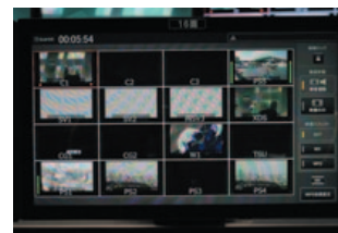
▲タッチパネルで急な素材差し替えにもスムーズに対応可能な16面操作端末
