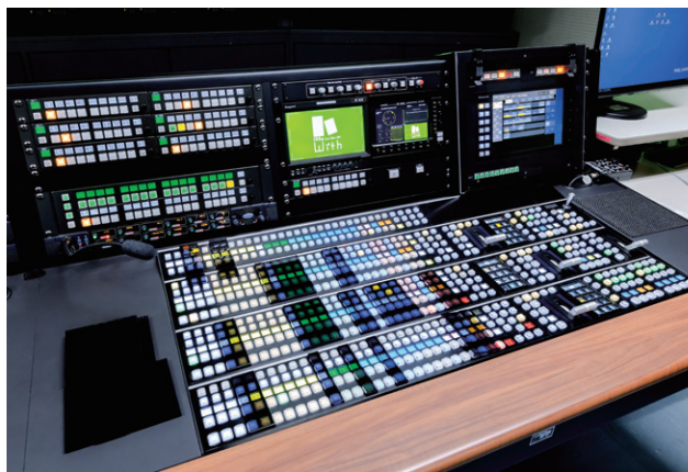
▲制作サブのライブスイッチャーAV-HS7300。なお、今回は制作・報道サブともに音声システムも納入した
