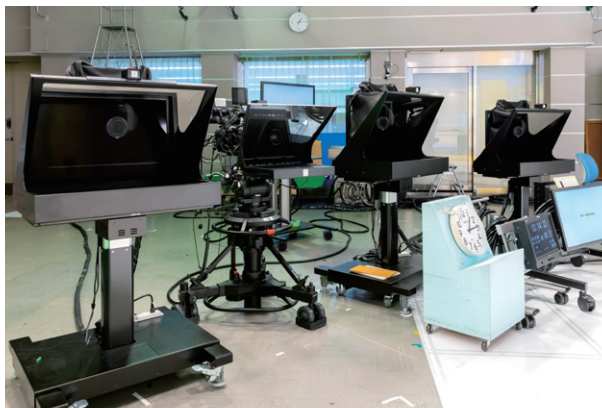
▲報道スタジオのリモートカメラ3台とスタジオカメラ1台。プロンプターに格納されている
