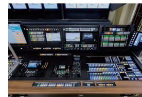
▲ライブスイッチャーAV-HS6000とROP、リモートカメラコントローラー
