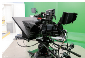
▲スタジオカメラAK-UC4000。スタジオカメラと同じROPでリモートカメラの色調整も可能
