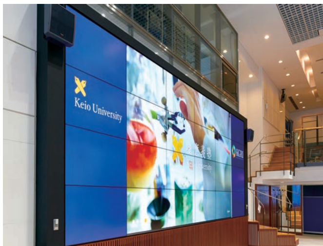
◀視死角が広く、どの席からみても鮮明な映像が見られるIPSパネル。右側面のマルチスクリーンにもリブレイスされたリモートカメラとスピーカーが設置されている
