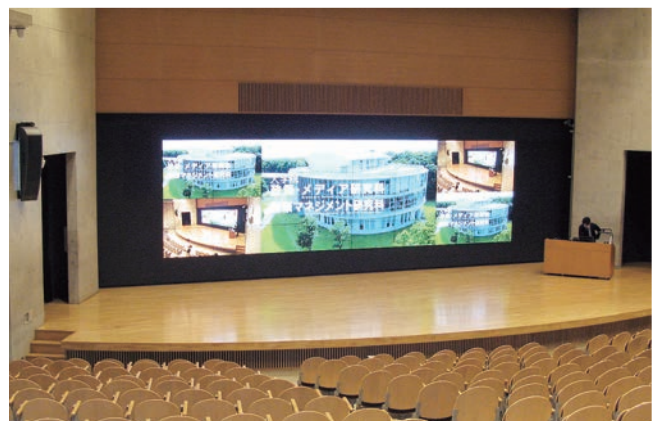
▲600名収容の大講義室に導入された32台の高輝度ディスプレイで構成されたマルチスクリーン
