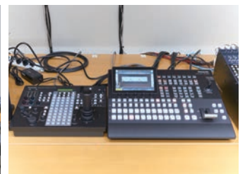
▲7階の編集室には、リモートカメラの確認用モニター、収録システム、ライブスイッチャーなどを設置
