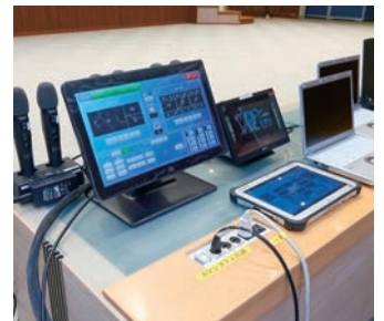
▲操作卓に備え付けのタッチパネルや、タブレットで映像・音響設備の操作を一括で行える
