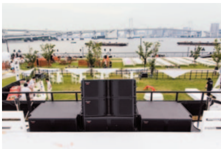
▲ サブウーハーWS-LA550AWPを3台並べ、センターにはWS-LA500AWPを2台スタック
