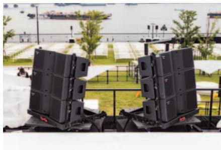
▲ VIPエリア中央に向けて設置された3連×2セットのWS-LA500AWP
