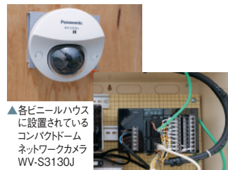
▲ビニールハウスのそばに設置されたIoTコントローラ PLC(FP7/31ES)
