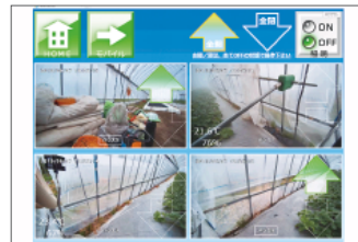
▲各ハウスごとに、ハウスの巻き上げ状態や温度・湿度が確認可能
