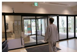
▲ 「ココファン吹田SST」の顔認証システム。あらかじめ顔登録した特定の人物をドアの左上に設置したカメラで撮影し検知する (画像は実証実験での様子)
