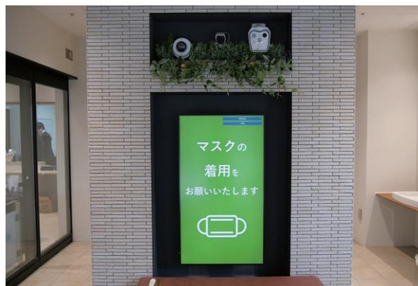
▲ 「ココファン吹田SST」のマスク非着用検知システム。カメラでマスク着用の有無を識別し、着用していなければ目の前のサイネージに着用を促すメッセージが表示される
