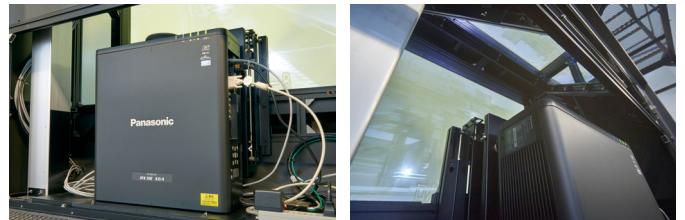
▲筐体を流用してのリプレースのためコンパクト性も重要な採用基準。PT-RX110JLBを上向きに設置し、上部のミラーに反射させスクリーンに投写させている
