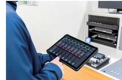
▲ 「iPad®用リモートコントロールソフト」を用いてiPad®から各WR-DX350の運用状況を遠隔で確認することが可能
