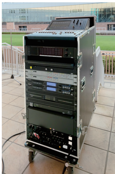
▲ デジタルミキサーWR-DX350やワイヤレス受信機が格納されたキャスター付き音響機器収納ワゴン。イベント用スペース3か所にそれぞれ設置されている
