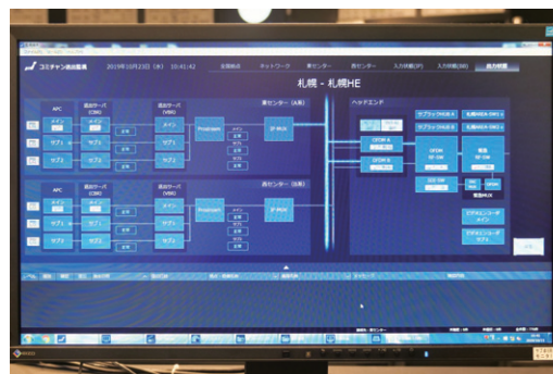
▲コミチャン送出監視「出力状態」画面で設備の状況をひと目で把握
