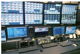
▲前列中央に配置されたメインの操作卓。映像をインジェストしたら自動でファイル検品も可能
