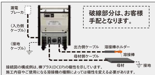
エンジン発電機について…溶接電源の定格入力kVAの2倍以上(単相適用機種の場合3倍以上)の容量のもので、ダンパー巻線を備えた発電機をご使用ください。
