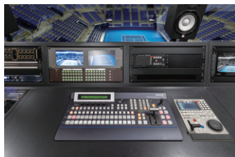
▲大型映像表示装置への出力素材をスイッチングするライブスイッチャーAV-HS450N
