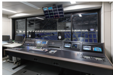
▲有明コロシアムの映像調整室。右側にHDインテグレートカメラ用のコントローラーを2台、中央にはライブスイッチャーを配置
