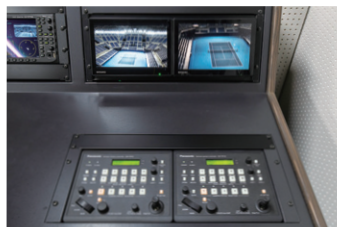
▲HDインテグレートカメラ用リモートカメラコントローラーAW-RP50
