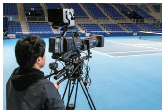
▲コート横のカメラ端子盤からSDIで映像伝送が可能なAJ-PX5100GJ
