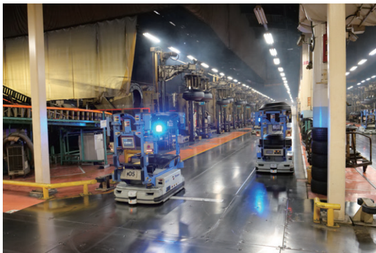
▲ 無人搬送機が走行する株式会社プリチストン様 甘木工場の加硫工程
