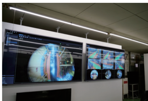
▲ AI全方位カメラの映像は3Dデワープ機能で見たい場所をズームしてモニタリング可能
