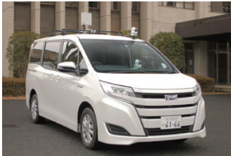
▲ 顔認証用、人物・物体検知用、車番認識用のカメラが搭載された移動体
