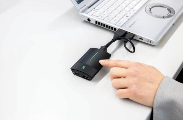
▲メインボタンで画面共有を開始。端のサブボタンを押すと最大4画面のマルチ画面に変更できる
