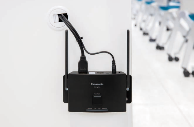
▲教卓の端に設置されたPressITの受信機。1台の受信機で最大32台の送信機に接続可能
