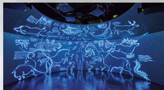
▲1チップDLP®レーザープロジェクターPT-RZ870JLを5台使って人間の視野角に近い210度をシームレスにプロジェクションしたエリア
