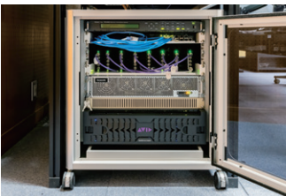
▲メインフレーム「Kairos Core 1000」は小型設計のため、コンパクトな防音ラックに格納可能
